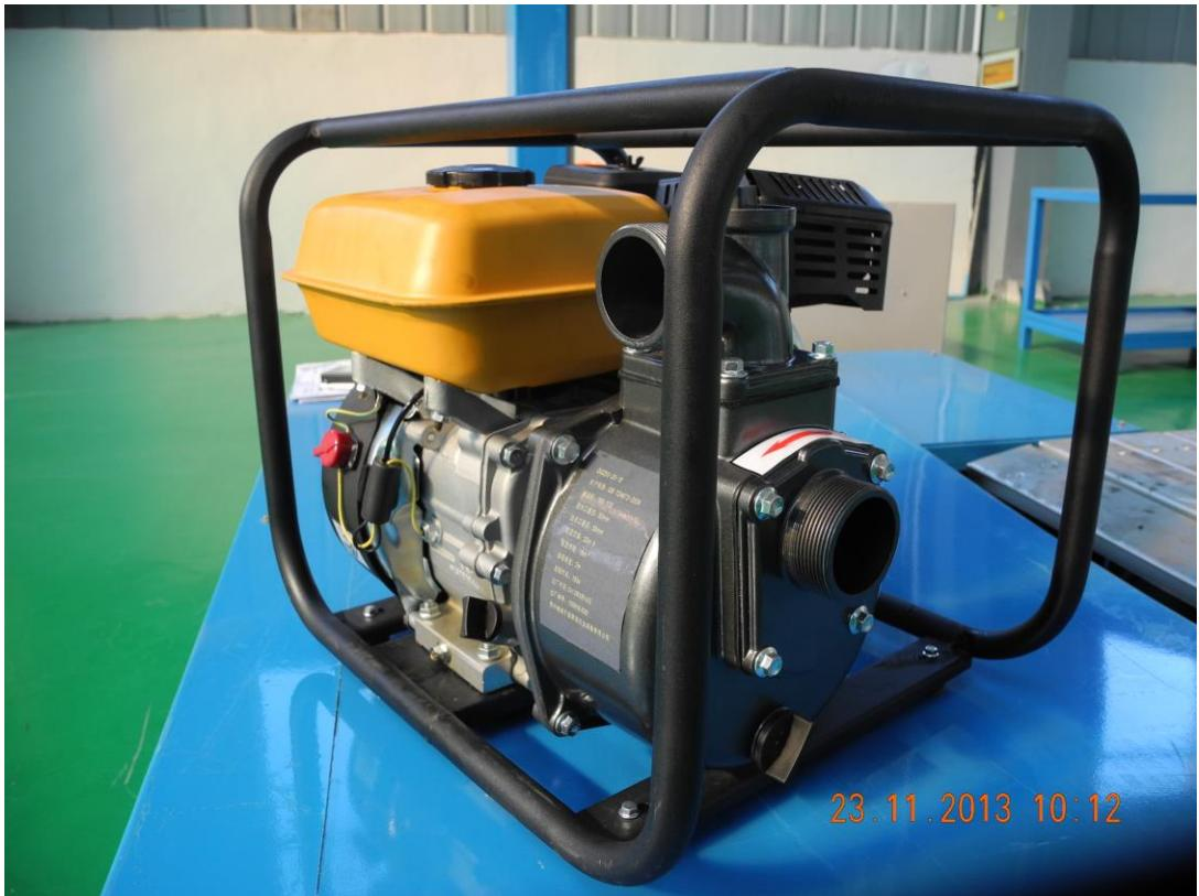
QGZ50-25-18 型自吸式小型汽油机直联高速离心泵
